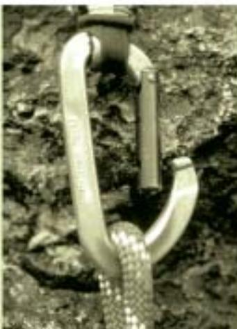
Häufiger Grund für eine Schnapper-offen-Belastung: man achte beim Karabinereinhängen einmal bewusst darauf und wird feststellen, wie oft diese Gefahr besteht. Zum Bruch reicht ein Sturz mit Fuß auf Hakenhöhe.
