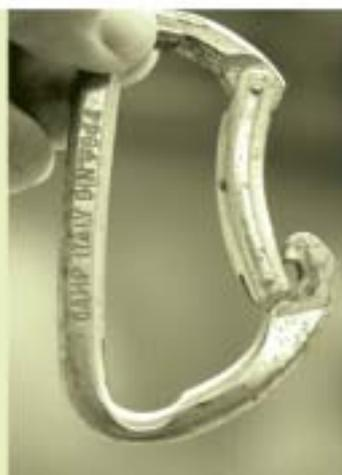
Eingeschliffener Karabiner. Für Topropeklettern und bei geschlossenem Schnapper noch kein Sicherheitsrisiko - doch Vorsicht: Schon wenn der Schnapper nicht ganz exakt geschlossen ist, besteht Bruchgefahr.
