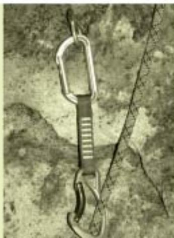
Vom Hersteller bereits vorgesehen: Querbelastung des unteren Karabiners nicht möglich (deshalb werden diese Karabiner auch nicht in Querrichtung geprüft).
