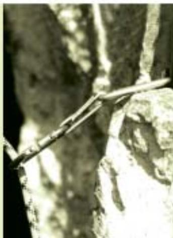
Bei Sturzbelastung wird der obere Karabiner auf Biegung belastet (fälschlicherweise häufig als "Knick"belastung bezeichnet). Bisher ist nur ein einziger Karabinerbruch dieser Art bekannt geworden.
