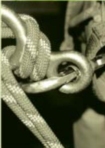
Wenn der Achter beim Abseilen den Karabiner nicht korrekt in Längsrichtung belastet, sondern auf der Verschlusshülse zu liegen kommt, kann es zum Bruch derselben und zum selbsttätigen Aushängen des Achters kommen, was in der Regel mit einem Absturz endet.
