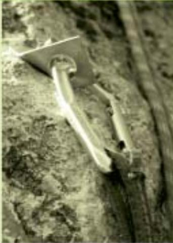
Scharfkantige Hänger führen bei häufiger Sturzbelastung zu Riefen und Kerben in der Karabinerrundung, die wiederum zur Seilbeschädigung führen können – bis hin zum Mantelriss.
