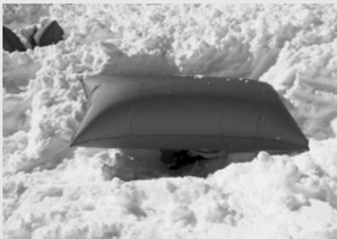
Mono- und Doppel-Airbag in der Lawine. Die Ballone waren an der Oberfläche zu sehen. Der Kopf konnte in kurzer Zeit freigelegt werden.
