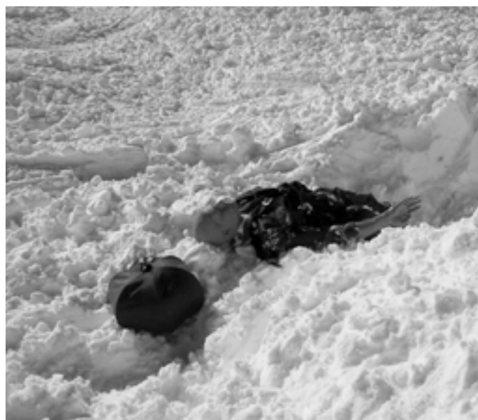
Der ausgegrabene Dummy mit dem Avalanche Ball. Der rote Ball war deutlich an der Oberfläche zu sehen und der Verschüttete konnte in kurzer Zeit ausgegraben werden.
