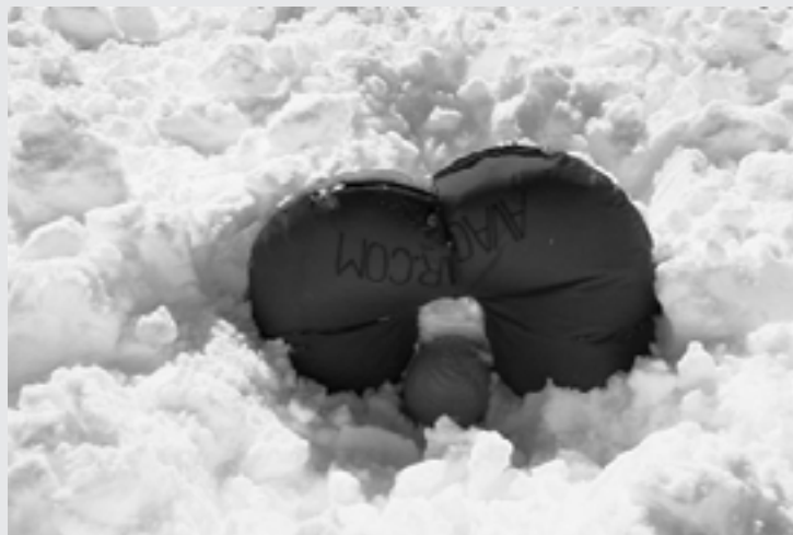
Avagear-Rettungsweste nach dem Lawinenabgang. Der aufgeblasene Ballon war gut an der Lawinenoberfläche sichtbar und der Kopf konnte rasch freigelegt werden.
