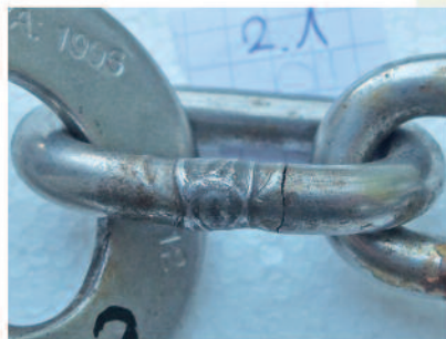
Abb. 3 Kettenglied mit feinem Riss gegenüber der Schweißnaht.
