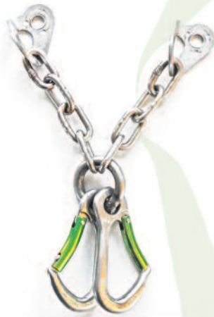
Abb. 2 Kettenglied mit mittleren Korrosionsspuren und einem deutlichen Riss.
