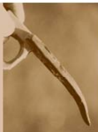
Eine besonders eigenwillige Kreation eines "Ring"-hakens, ein Stück Flacheisen mit einer Öse aus zusammengezwirbeltem Weidezaundraht; aus den Dolomiten stammend.
