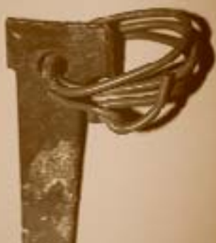
Eine besonders eigenwillige Kreation eines "Ring"-hakens, ein Stück Flacheisen mit einer Öse aus zusammengezwirbeltem Weidezaundraht; aus den Dolomiten stammend.
