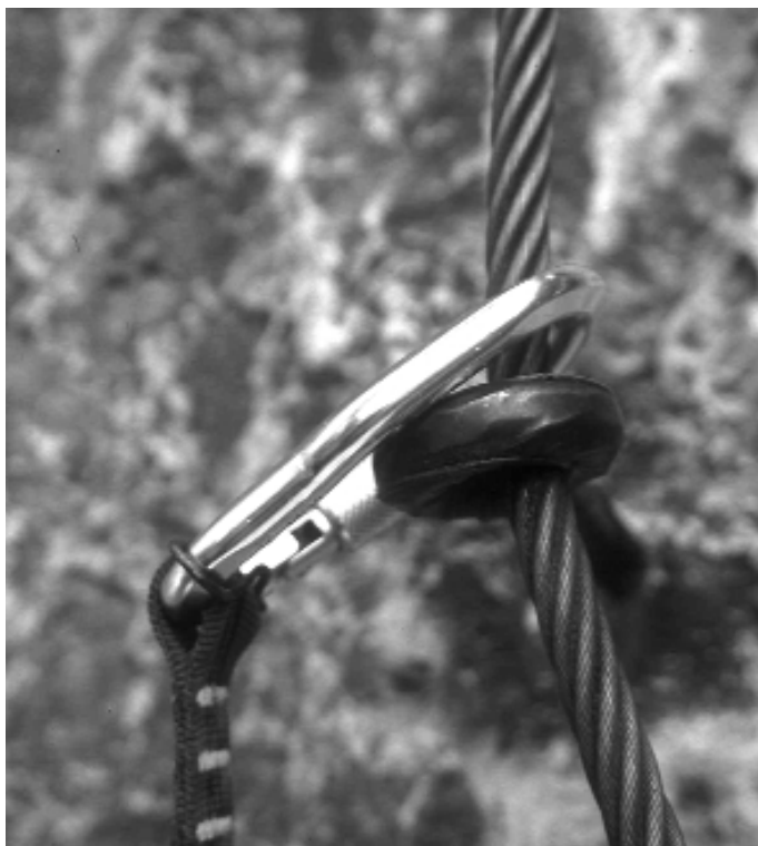
Bild 2, 3: Typische Biegebelastung von Klettersteigkarabinern bei Sturz. Noch gibt es in den Normen keine derartige Belastungsprüfung für Klettersteigkarabiner. Werden wie beim Y-Set - immer beide Karabiner eingehängt, ist das Karabinerbruch-Risiko praktisch Null.
