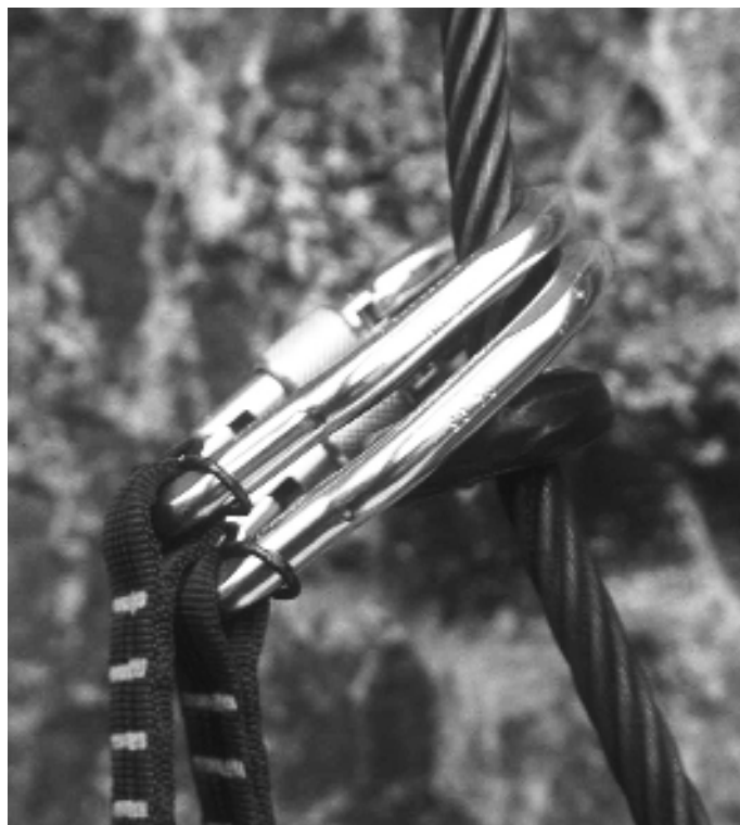
Bild 2, 3: Typische Biegebelastung von Klettersteigkarabinern bei Sturz. Noch gibt es in den Normen keine derartige Belastungsprüfung für Klettersteigkarabiner. Werden wie beim Y-Set - immer beide Karabiner eingehängt, ist das Karabinerbruch-Risiko praktisch Null.
