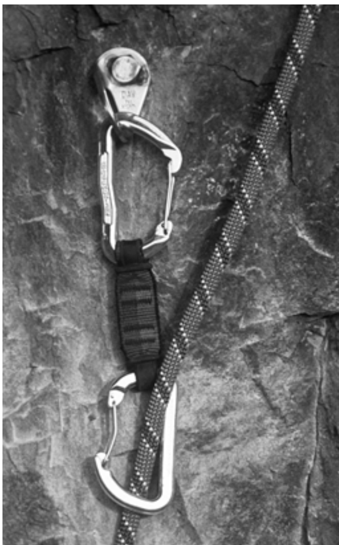
Abb. 4: Gerader Schnapper immer oben, gebogener Schnapper immer unten - so besteht keine Gefahr fürs Seil
