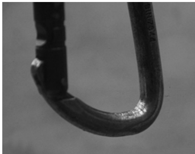
Abb. 2: Typische Kerben durch Sturzbelastung in scharfkantige Hänger
