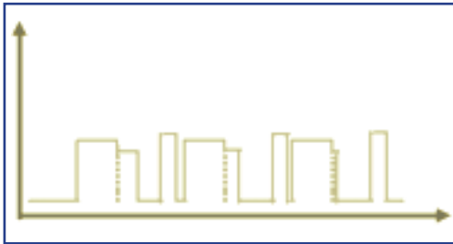
Diagramm 1: Mehrere Sender werden mehr oder weniger gleich stark empfangen. Es ist schwierig, ein bestimmtes Signal zu isolieren und einen Verschütteten systematisch zu lokalisieren.
