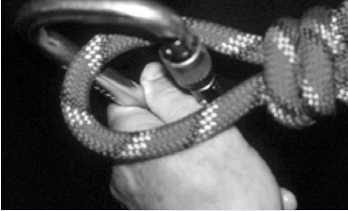
Wird der Schraubverschluss nicht festgezogen, kann er durch Bewegung der Seilschlinge aufgedreht werden.
