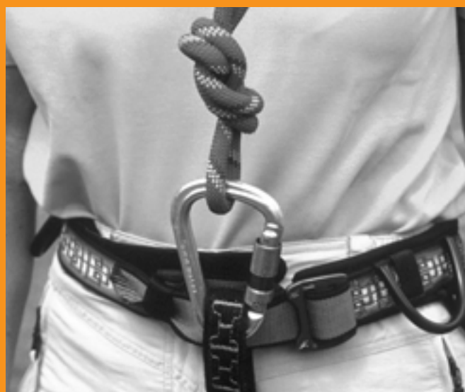
Typisches Anseilen beim Toprope-Klettern (links). Zwei Karabiner, parallel und gegenläufig eingehängt, schaffen Redundanz. Dass sich beide Karabiner ungewollt öffnen, ist technisch und statistisch auszuschließen.
