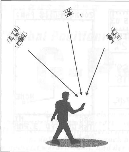
Die GPS Navigation basiert auf der Entfernungsbestimmung zu Satelliten. 3 oder 4 Satelliten reichen aus, um durch Berechnung der Zeitdifferenzen zwischen den gesendeten Signalen mit Hilfe des GPS-Empfängers die augenblickliche Position zu bestimmen.
